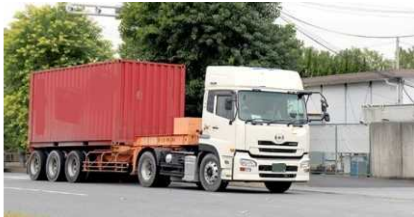
20ft カウンターウエイト付3軸トレーラ 最大積載24t(コンテナ自重込) 連結車両総重量 最大37.5t
