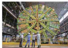
国内最大断面のシールドマシン
