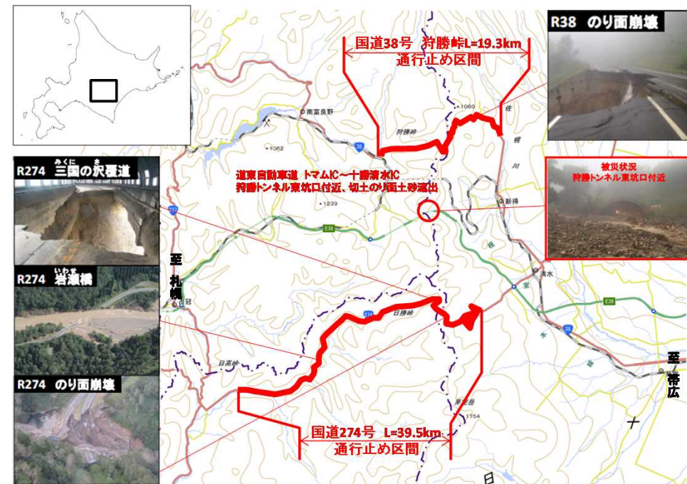
▼ 平成28年台風10号による道路被害状況
