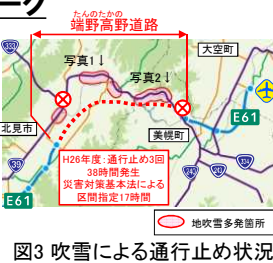
図3 吹雪による通行止め状況
