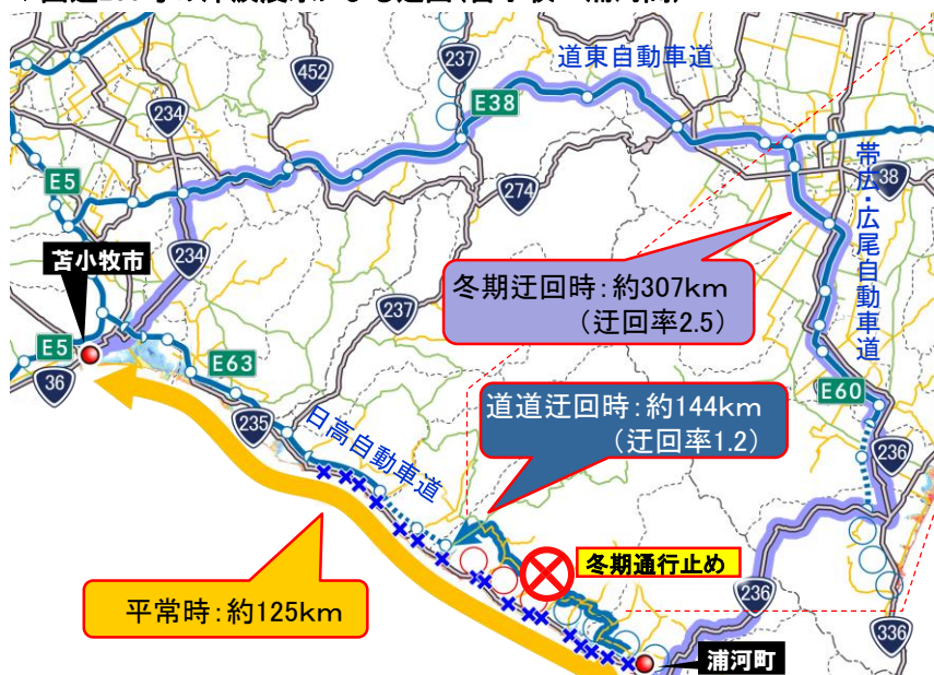
▼国道235号の津波浸水による迂回(苫小牧～浦河間)
