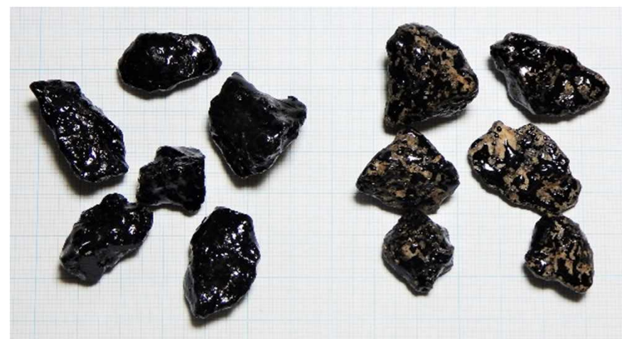
はく離しやすい6号碎石を用いた静的剥離試験結果の一例 左：HRバインダーECO-W、右：ポリマー改質アスファルトⅡ型
