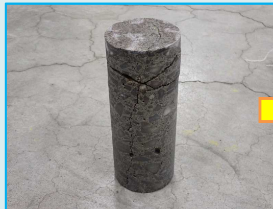
鉄網・縁部補強鉄筋の腐食および界面からのコンクリート版のひび割れ・剥離 (コア採取)
