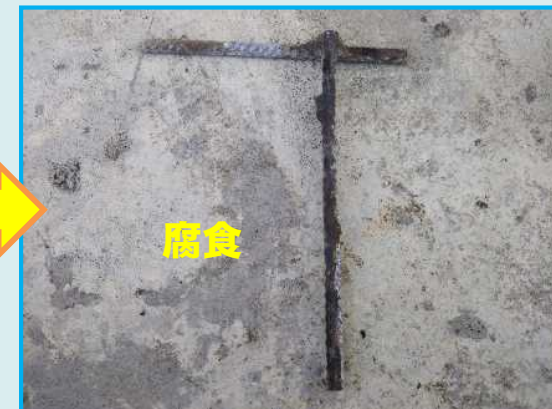
鉄網・縁部補強鉄筋の腐食および界面からのコンクリート版のひび割れ・剥離 (開削調査)
