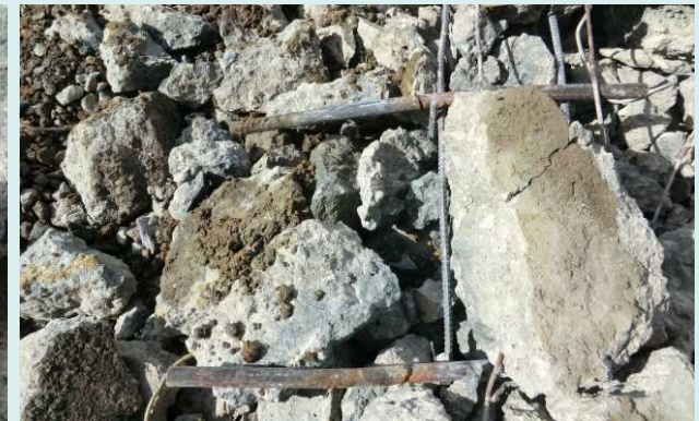
ダウエルバーの腐食・破断
