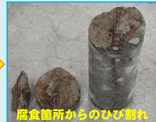
鉄網・縁部補強鉄筋の腐食および界面からのコンクリート版のひび割れ・剥離 (コア採取)
