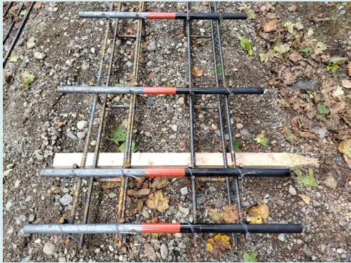
従来型 : 丸鋼 (さび止めペイント)
