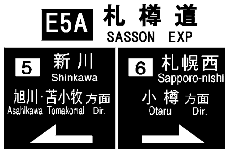
図1.8.16 ハーフインターチェンジの入口の方向案内レイアウト参考例
