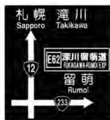
図1.8.19 108系の標識に高規格幹線道路の通称名を表示したレイアウト参考例
