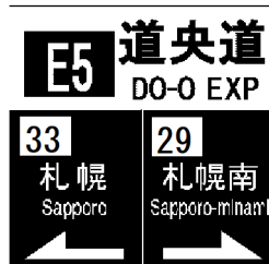
図1.8.9 入口の方向（103-Bの変形）レイアウト参考例
