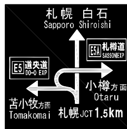
図1.8.11 方面および方向（108の2-C）レイアウト参考例
