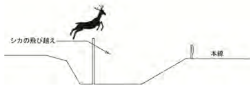
図1.12.4 地形条件で柵高の検討が必要な事例
