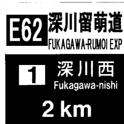
図1.8.7 入口の予告（104の変形）レイアウト参考例
