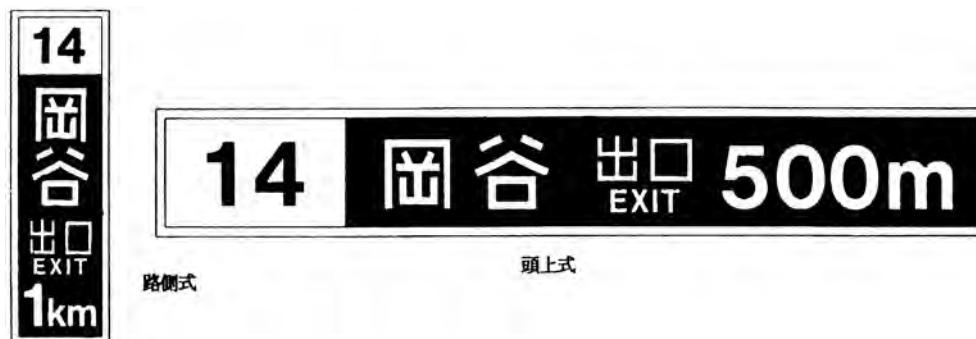
図1.8.39 トンネル内出口案内標識（内部照明）（参考図）
