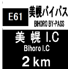
図1.8.26 自動車専用道路の市街地案内標識レイアウト参考例
