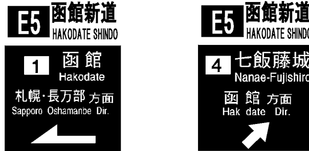
図1.8.12 ハーフインターチェンジ等の入口の方向案内レイアウト参考例
