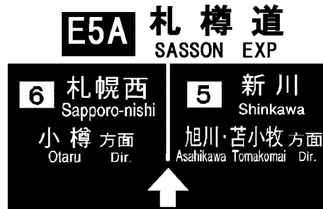
図1.8.17 ハーフインターチェンジの入口の方向レイアウト参考例
