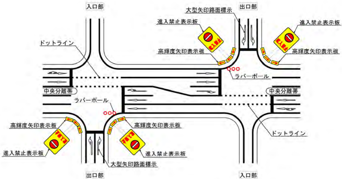
図1.17.3 ダイヤモンド型IC出入り口部 逆走対策工配置図（参考）
