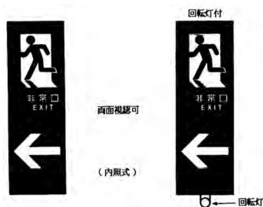
図1.8.73 非常口表示灯
