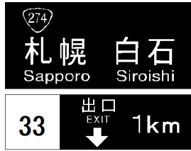
図1.8.37 方面、車線および出口の予告（111-A）
