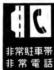
図1.8.55 非常駐車帯、非常電話併設標識
