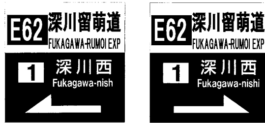
図1.8.6 入口の方向（103-Aの変形）レイアウト参考例
