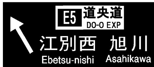
図1.8.22 ジャンクションの案内標識板（車線推奨の場合）レイアウト参考例
