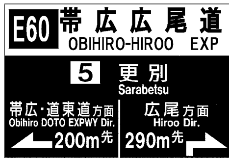
図1.8.13 ダイヤモンドインターチェンジ入口の方向案内レイアウト参考例
