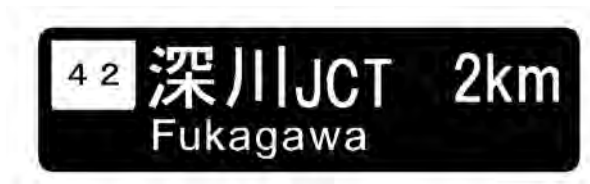
図1.8.23 ジャンクションにおける2 km 予告標識レイアウト参考例
