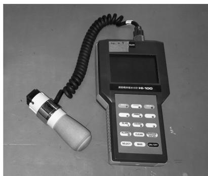
写真-2 表面水分計（電気抵抗式）
