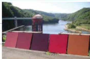
色見本パネルを使用した 現地確認の様子
