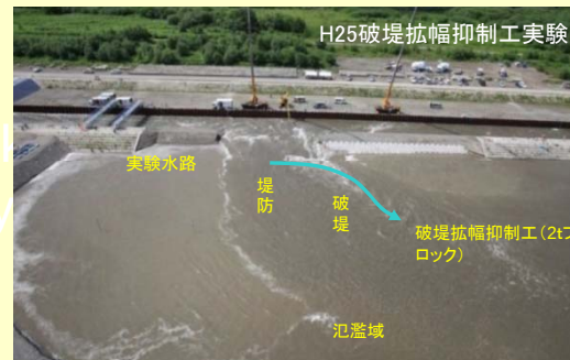
実物大スケールの十勝川千代田実験水路における堤防決壊メカニズム及び決壊時の氾濫被害軽減に向けた実験
