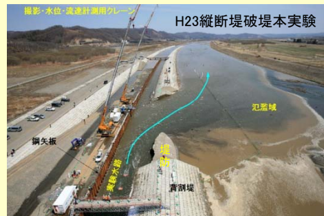
実物大スケールの十勝川千代田実験水路における堤防決壊メカニズム及び決壊時の氾濫被害軽減に向けた実験
