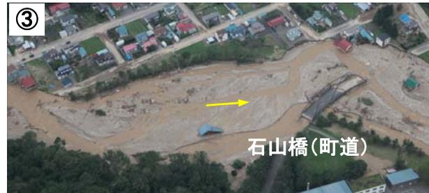
▲ 乱流により欠壊した護岸, 流出した町道
