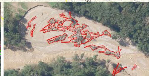
▲堆積流木の面積計測
