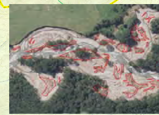
▲堆積流木の面積計測
