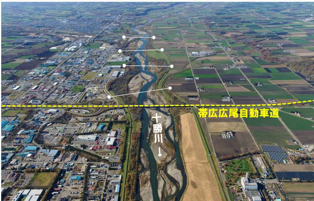
連続盛土等の構造物により、浸水被害の拡大が軽減される可能性がある。
