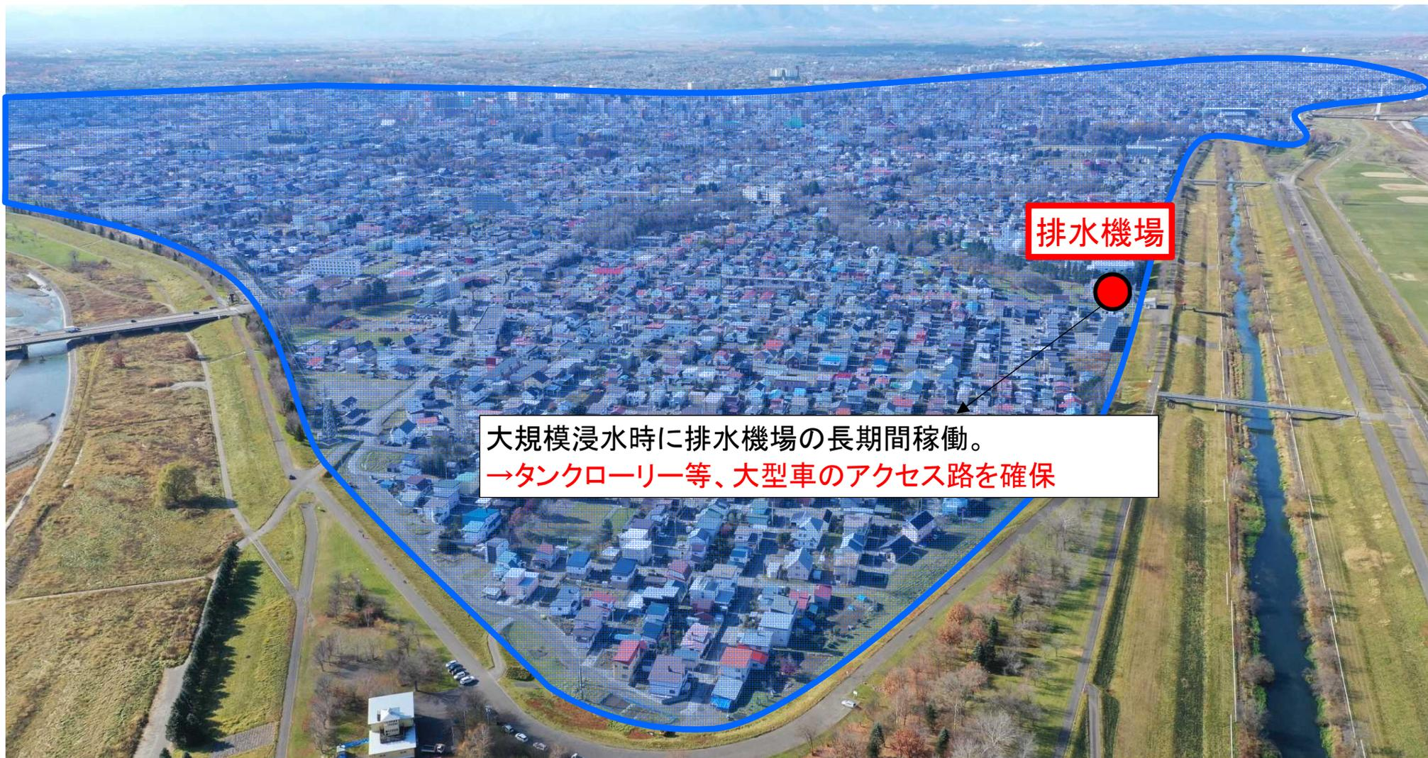
内水・外水の機場排水は、洪水中やその後の迅速な湛水解消に重要な役割を果たす。稼働時間が長期になるため、燃料の補給や修理作業員のアクセス確保が重要となる。
