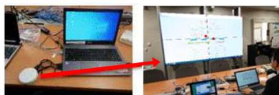
自席のパソコンに設置された切替器を使うと大型モニター等へ映像をワイヤレスで配信
