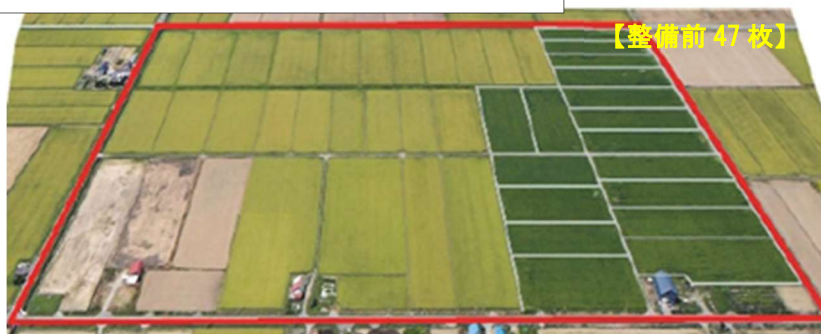
【整備前のほ場区画状況(田：平均 0.5ha)】
