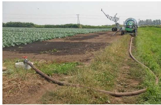
写真：給水栓と散水機
