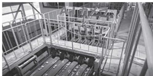
写真：AIカメラによる自動選別
