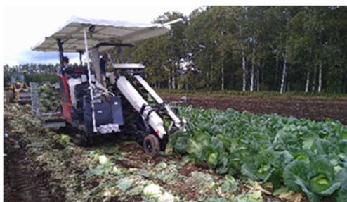
写真：キャベツ機械収穫
