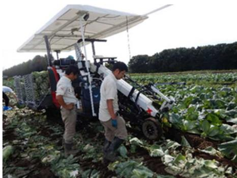
写真：現地検討会（キャベツ自動運転収穫機）
