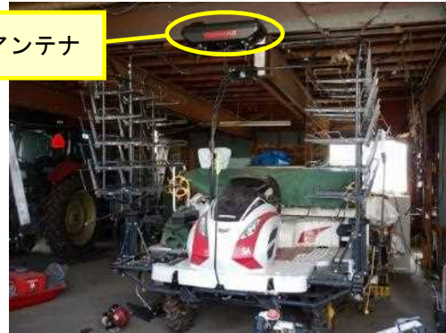
写真：自動制御による直進 アシスト付き田植え機 (令和2年8月撮影)
