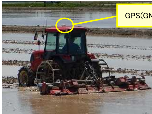
写真：走行経路ガイダンス付き トラクターによる代かき (令和2年5月撮影)
