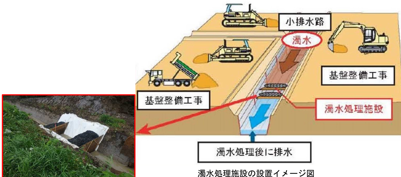
濁水処理施設の設置状況 (R元年6月撮影)
