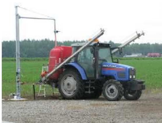
写真：多目的給水栓による防除用水の給水
