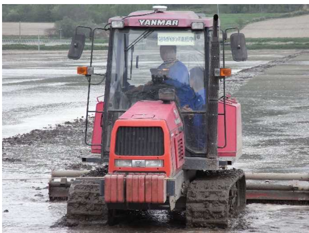
GPSガイダンス搭載型トラクターによる 代掻き作業 (H24年7月撮影)
