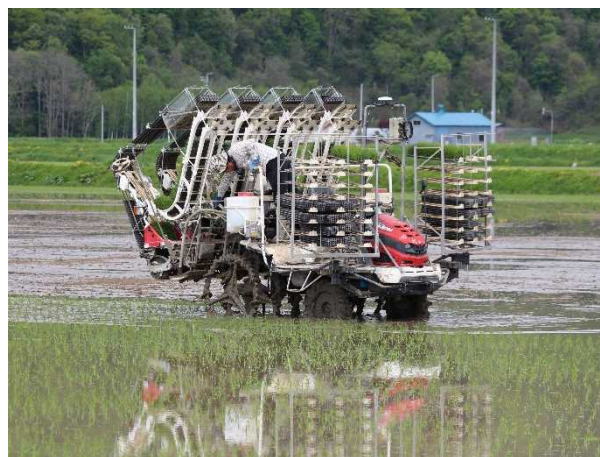
GPSガイダンス+自動操舵システム装着 田植機による移植作業 (H30年5月撮影)
