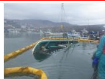
越波による漁船沈没状況
