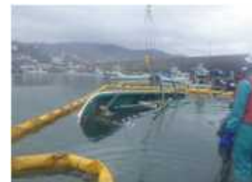
越波による漁船沈没状況
