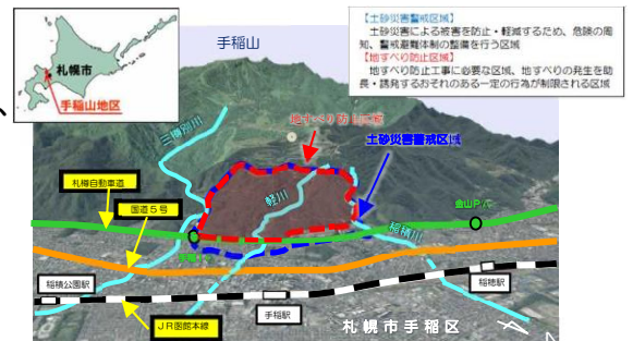
手稲山地区直轄地すべり対策事業
