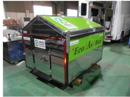
アスファルト舗装合材運搬時の保温資材の活用
