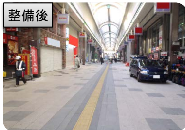
整備後 道路中央に点字ブロックを敷設。 24時間歩行者専用化。
