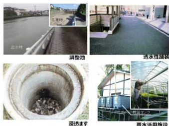
雨水貯留浸透施設の例
