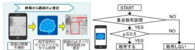
新たな機能の試行 (路面映像を基にAI活用し”すべり摩擦係数”を推定)
