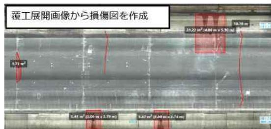
覆工展開画像から損傷図を作成
