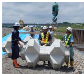
実験に用いるコンクリートブロック（トラスフット2t型）
