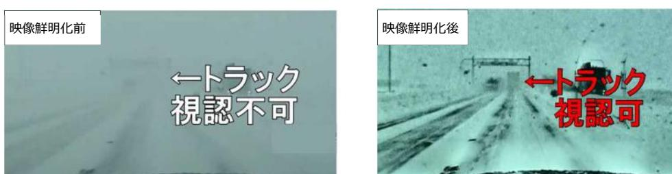
ホワイトアウト時でも 約100m先まで視認可能。吹雪時の除雪作業の継続が可能となり天候回復後速やかに通行を再開
