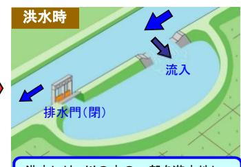
洪水には、川の水の一部を遊水地に溜め込み、川の水位を下げる。
