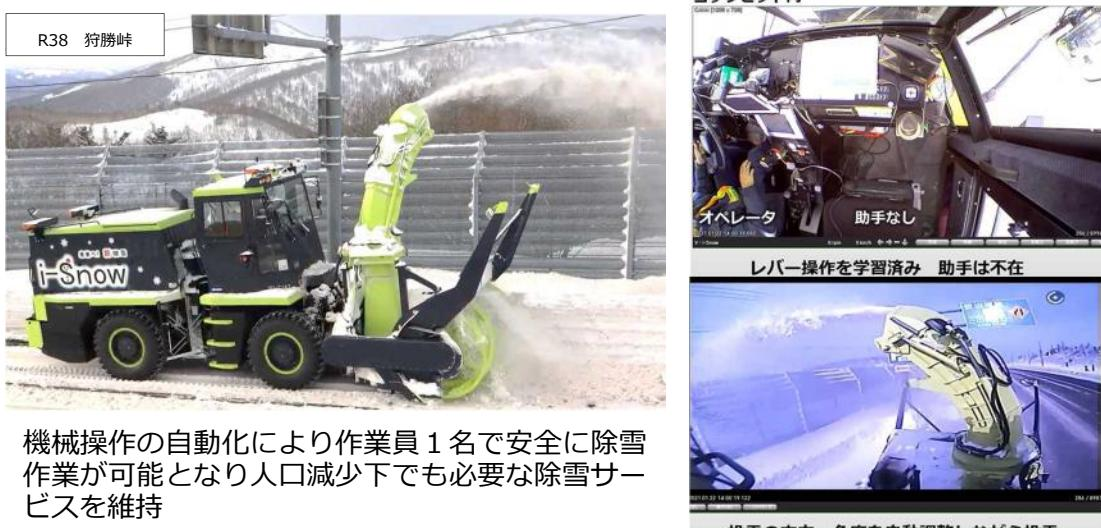
機械操作の自動化により作業員1名で安全に除雪作業が可能となり人口減少下でも必要な除雪サービスを維持
