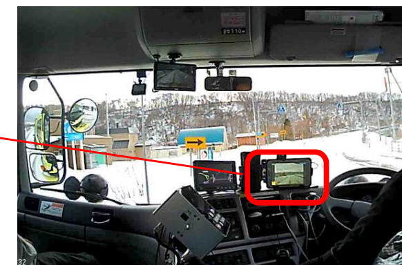
AR機器を除雪車両へ搭載 〔モニタリング調査状況〕
