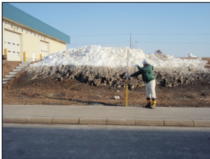
岸壁背後道路の隣接部分の残雪の津波痕跡（地盤から1.5m程度）
