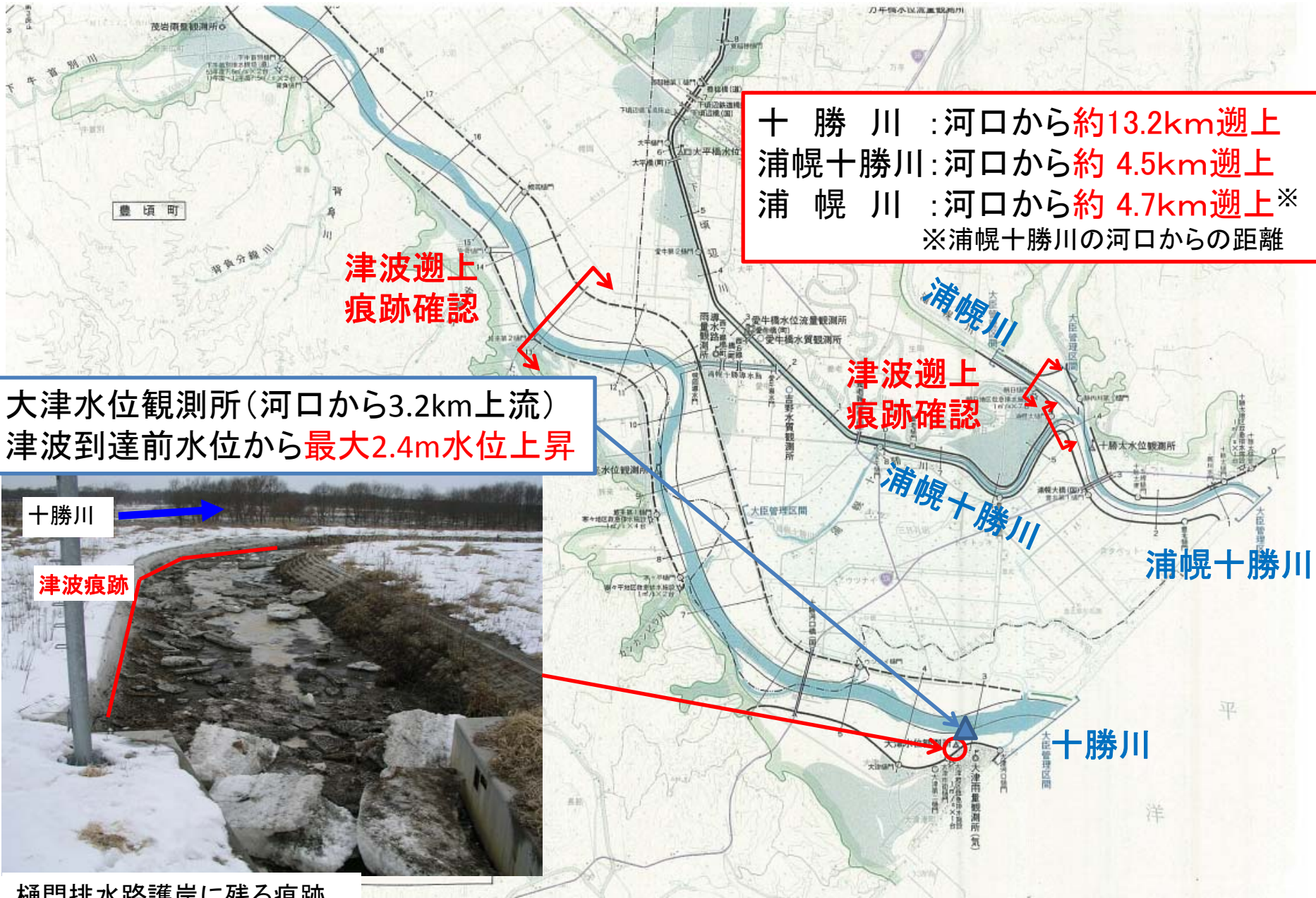
樋門排水路護岸に残る痕跡。
