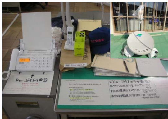
【岩手県田野畑村】 Ku-SATによる電話回線確保
