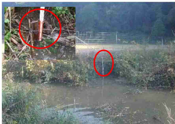
写真 4-21 水位計の設置
