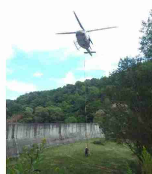
写真 4-22 ヘリによる投下型水位観測ブイ運搬
