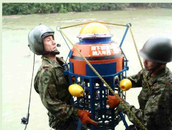
投下型水位観測ブイ投下状況
