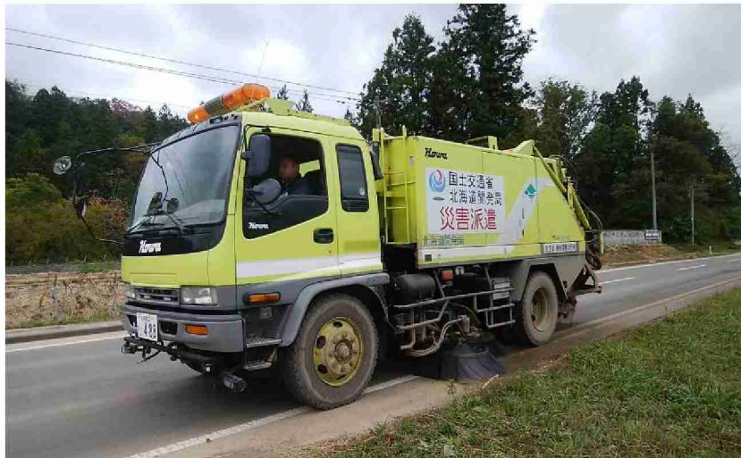
路面清掃車等による路面清掃作業 (宮城県丸森町)
