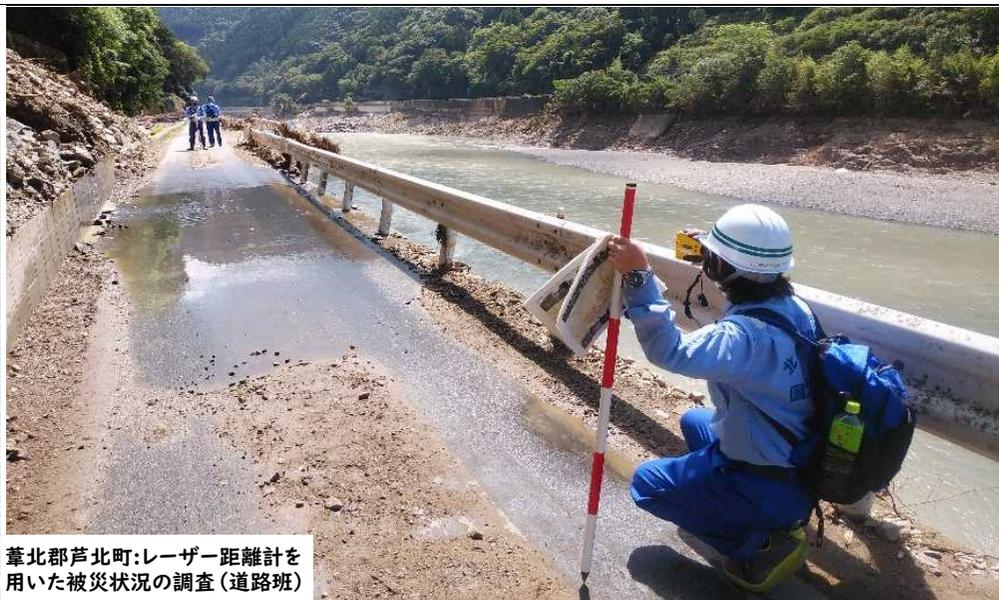
葦北郡芦北町：レーザー距離計を用いた被災状況の調査（道路班）
