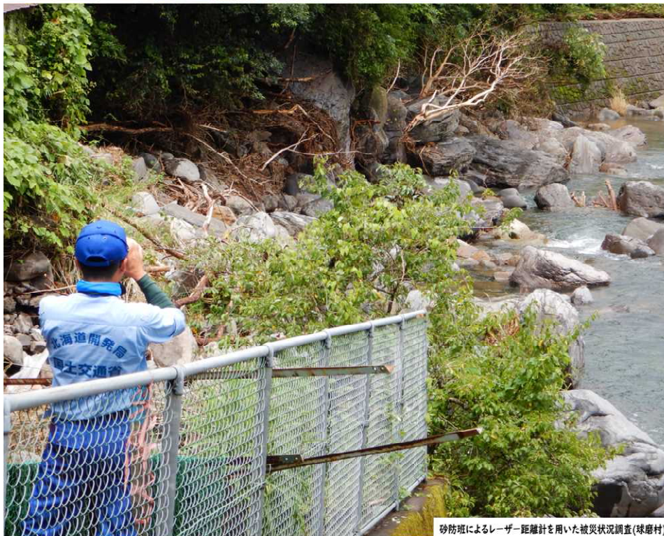
砂防班によるレーザー距離計を用いた被災状況調査(球磨村)
