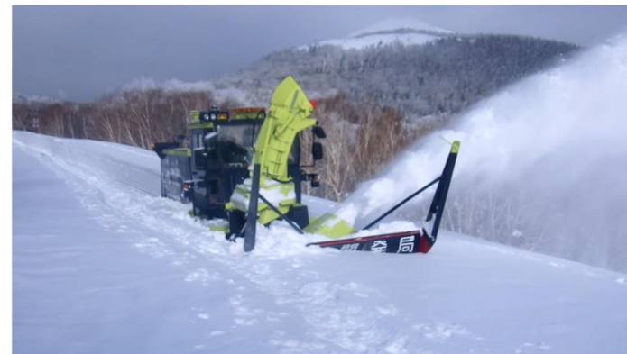
▲ 『除雪装置自動制御付』ロータリ除雪車 国道334号知床峠（斜里側）による投雪作業（R8）
