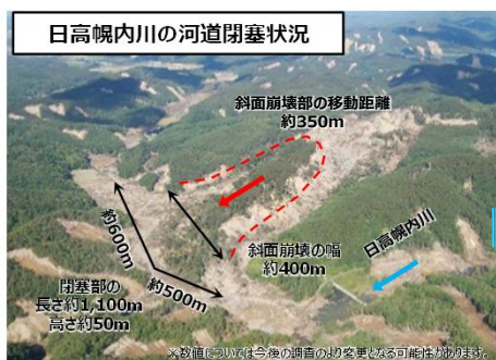
日高幌内川では、山腹崩壊により大規模な河道閉塞が発生
