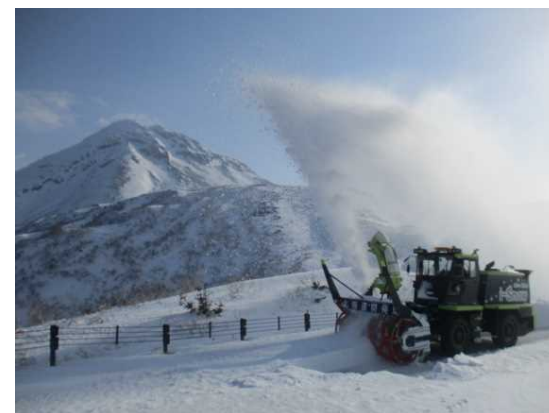
▲ 『除雪装置自動制御付』ロータリ除雪車 国道334号知床峠（網走側）で配備
