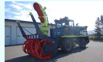
『除雪装置自動制御付』ロータリ除雪車
