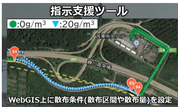
各種散布条件（区間、散布量、散布幅など）をWEBサーバに作成
