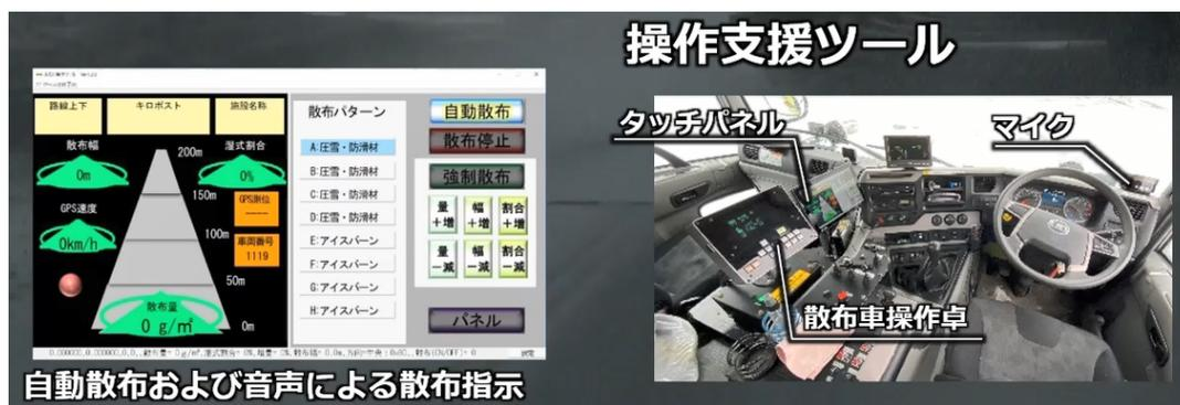
設定した散布条件のほか、任意での自動散布も可能（音声・手動の切替が可能）
