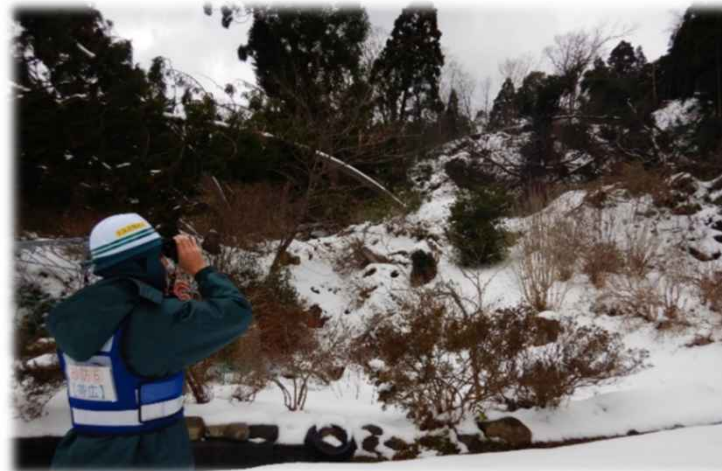
レーザー距離計を活用した調査の様子
