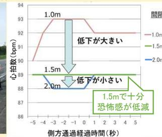
図:側方通過経過時間に伴う心拍数変化(側方通過速度60km/hの場合)
