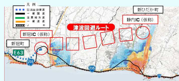
地元自治体の地域防災計画等の見直しにより、津波浸水域を回避するルートに見直しをした日高自動車道
