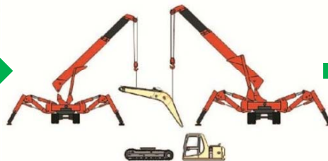
災害現場にて各パーツを組立
