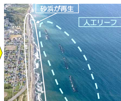
白老工区人工リーフによる砂浜の再生（左：着手前、右：整備後）
