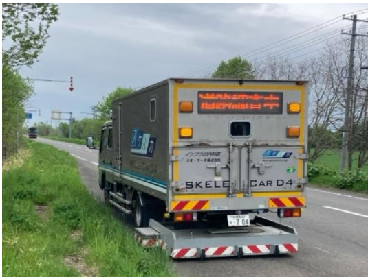
路面下空洞調査状況
