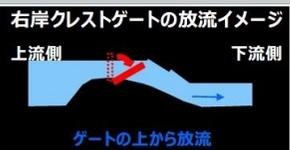
右岸クレストゲートは、小さな増水に対応するためのゲートで、洪水期（7月～9月）に使用しています。水を越流させるゲートで、ゲートを寝かせたり起こしたりして流量を調節します。
