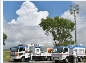
災害対策用機械の説明 排水ポンプ車(左)と照明車(右)
